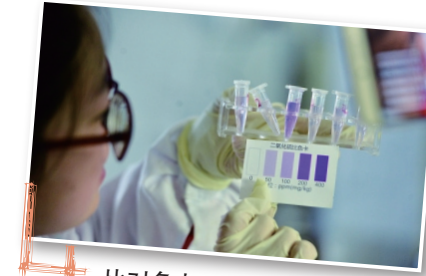
对比色卡，3 号样品二氧化硫含量在 100mg/kg-200mg/kg 之间
