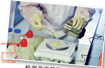
检测员将筷子分段粉碎称取 1g 样品
