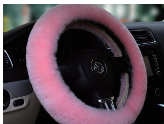
这种毛绒绒的方向盘套尺寸较大，司机不好掌握，且其材料在发生起火事故时，会变成极危险的易燃物。
